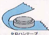
図 2.2.1 ボタン電池の絶縁方法例 7
