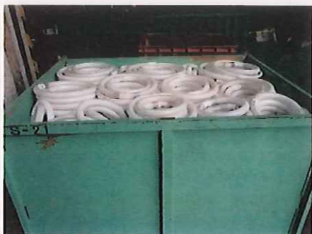
写真 2.4.3 蛍光灯の保管容器の例 (出荷時は蓋をする)
