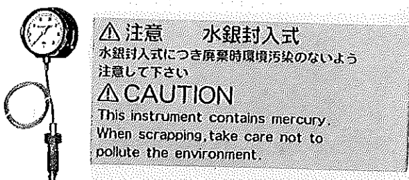
(写真) 高温用ダイヤフラムシール圧力計と注意銘板の例
