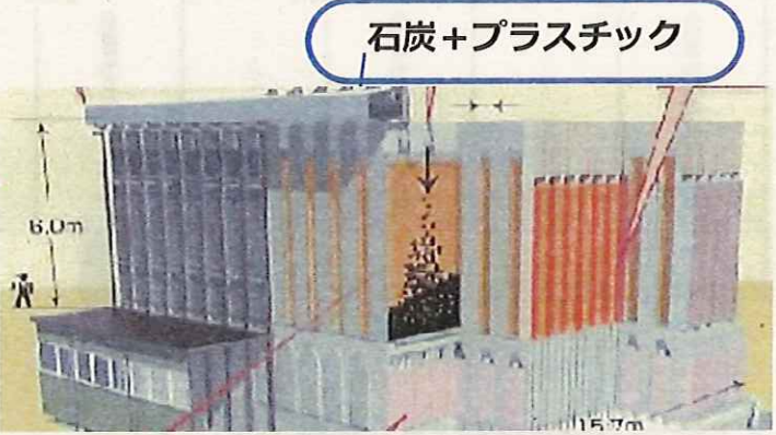
● コークス炉の構造と熱分解進行状況
