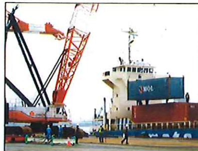
仙台港 震災後のクローラクレーンによる初荷役風景(GT使用不能時)
