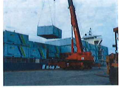
200トントラッククレーン
