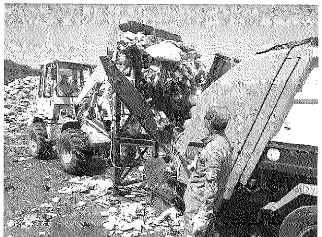
写真7 ごみの搬送のための積み込みの様子
